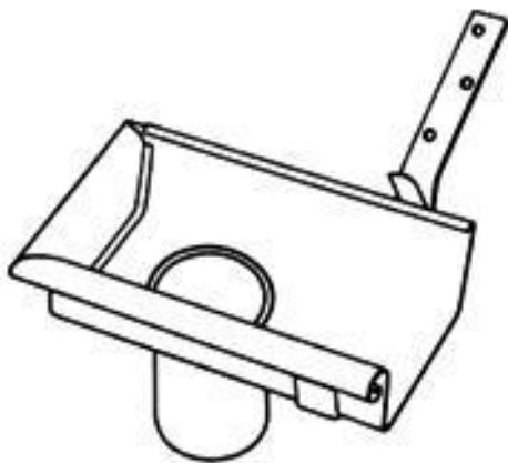
Fig.20 montage van expansie/ broekstuk
